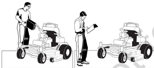
Prima di fare della pulizia, rifornire l'unità di carburante o eseguire operazioni di manutenzione, disimpegnare sempre tutte le trasmissioni, spegnere il motore e togliere la chiave.
