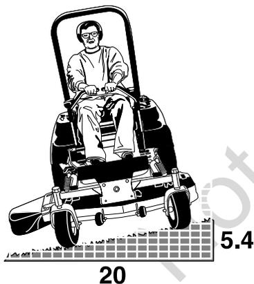
L'uso su terreno in pendenza può essere pericoloso. L'uso su terreni in eccessiva pendenza dove non si ha adeguata trazione (e controllo) delle ruote può causare slittamenti, perdita dell'abilità di curvare, perdita di controllo e la possibilità di cappottare. Non si dovrebbe usare la macchina su terreni con una pendenza superiore a 1.6 m di differenza in altezza su una distanza di 6 m (5.4 piedi in altezza su 20 piedi di distanza) (15°).
