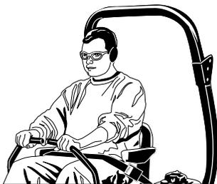
Tenere la barra di sicurezza in posizione alzata e allacciare la cintura di sicurezza. Non c'è protezione in caso di cappottata quando la barra è abbassata. Non saltare fuori se l'unità si rovescia (è meglio essere seduti sul sedile con la cintura di sicurezza allacciata e con la barra di sicurezza alzata).
