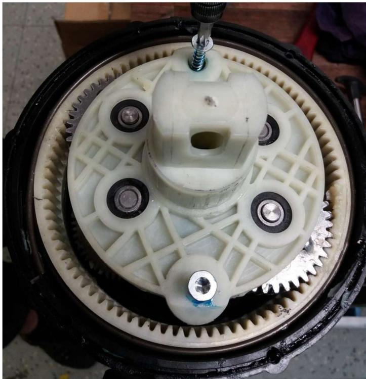
**SMONTAGGIO 2° PERNO MOTORE: 2 VITI (TORX T30)**
