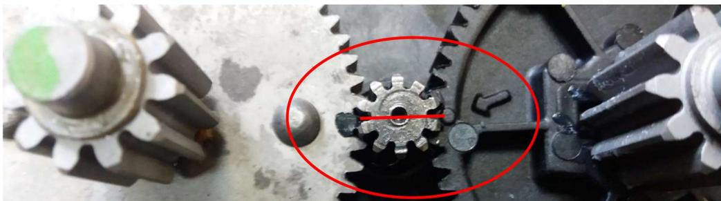
**NOTA: PER LE VERSIONI PRECEDENTI DI MOTÚČKA UTILIZZIAMO ENTRAMBI I PIGNONI M1.25 PLASTICA - PA 6.6 CON IL 60% DI FIBRE DI VETRO, RETICOLATA PER IRRAGGIAMENTO - PER ALTRI MOTÚČKA UTILIZZIAMO UNA COMBINAZIONE DI HYBRID = 1 RUOTA IN ACCIAIO NITRURATO + 1 RUOTA IN PLASTICA IN PA 6.6 CON IL 60% DI RADIAZIONE DI FIBRE DI VETRO IN RETE**
