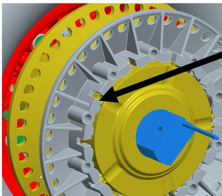
2. Posizionare l'argano sul corpo del riduttore e praticare i fori di montaggio nel corpo con una punta da  $\varnothing 5$  mm a una profondità di 25 mm - 5x.
