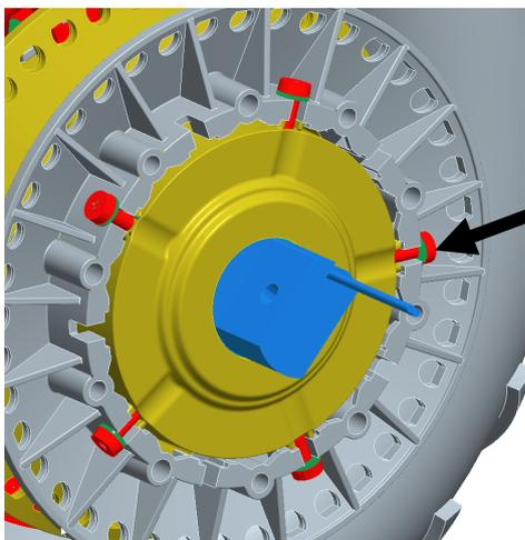
3. Posizionare l'argano sul corpo del riduttore e fissarlo con una vite 6x30, posizionare le rondelle delle ventole sotto le teste delle viti.
